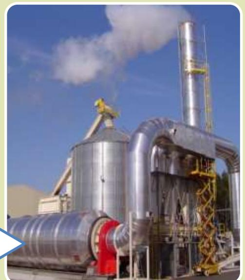
Nesta fase industrial iniciamos como processo de refinação e de moagem industrial. A matéria-prima seca será transportada para a fase de refinação e de moagem (refinação de modo que a partícula seja reduzida ao tamanho máximo 2mm - redimensionamento da matéria-prima) e trituração para ser homogeneizado relativamente à dimensão, através de moinhos de martelos.
