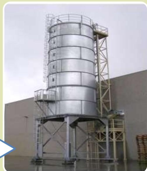
Nesta fase industrial iniciamos como processo de geração de energia térmica e de secagem industrial da matéria-prima úmida que passou pelo processo de alimentação e preparação industrial. A matéria-prima (serragem, maravalha ou cavaco de madeira) são transportados para a secagem industrial (obtenção de um conteúdo de umidade no máximo 14%).
