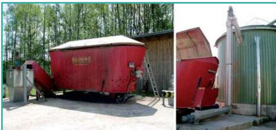
Carregamento de biomassa empilhável com transportador helicoidal
